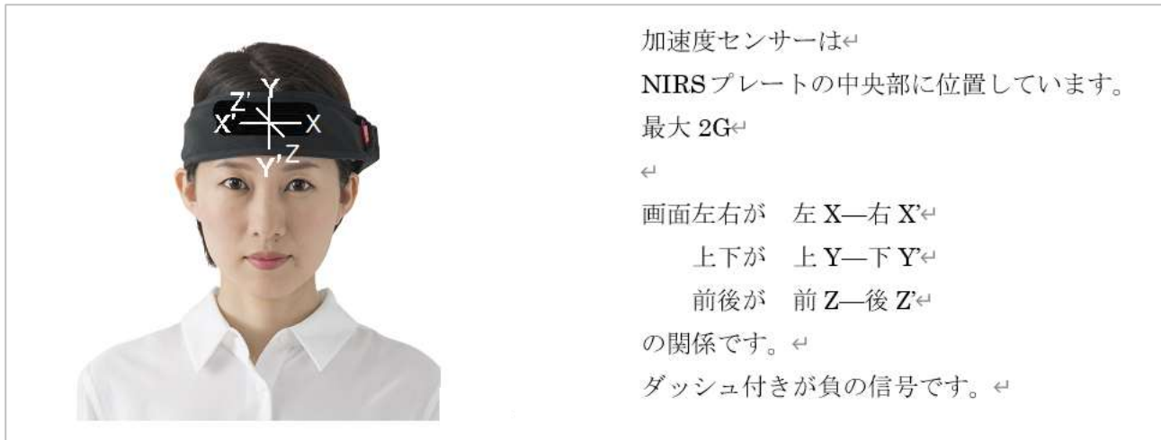
図 7 加速度センサーの方向
