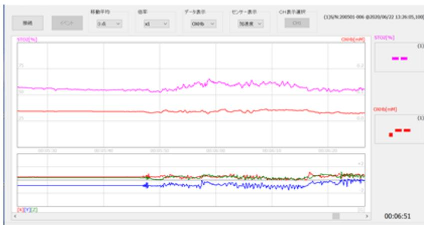
メニュー [ファイル (F)] [開く (O)] で csv ファイルを選択すると、読み込んで波形が表示されます。グラフ左上と画面左下には、読み込まれたデータの情報が表示されます。波形表示エリアのグラフには、上に時刻、下に測定開始からの経過時間が表示されます。
