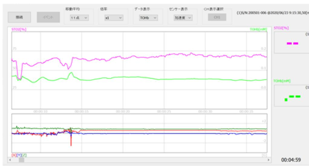
グラフ右上には、読み込まれたデータの情報が表示されます。測定開始日付、機器 ID、サンプリングレート、脂肪厚みなどです。
