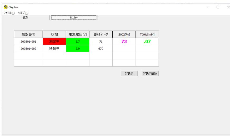
状態：動作状態、待機中、又は蓄積モード測定中を示します。
